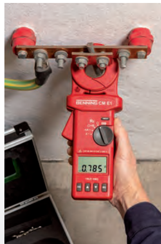
Messung des Erdschleifenwiderstandes eines Anlagenerders
