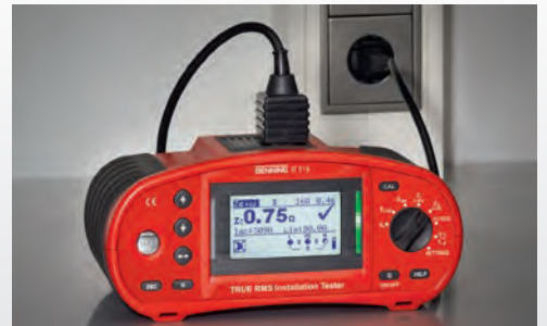
IT 115 bei der Schleifenimpedanzmessung ohne RCD-Auslösung
